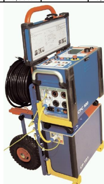
CPC 100 + CP TD1 Установка для змерений \tan \delta и \cos
