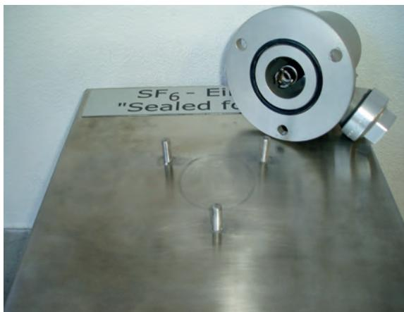
Фиксирование сварной шпильки перед монтажем на поверхности.
