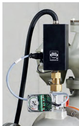
Соединительная коробка монитора плотности в собранном состоянии
