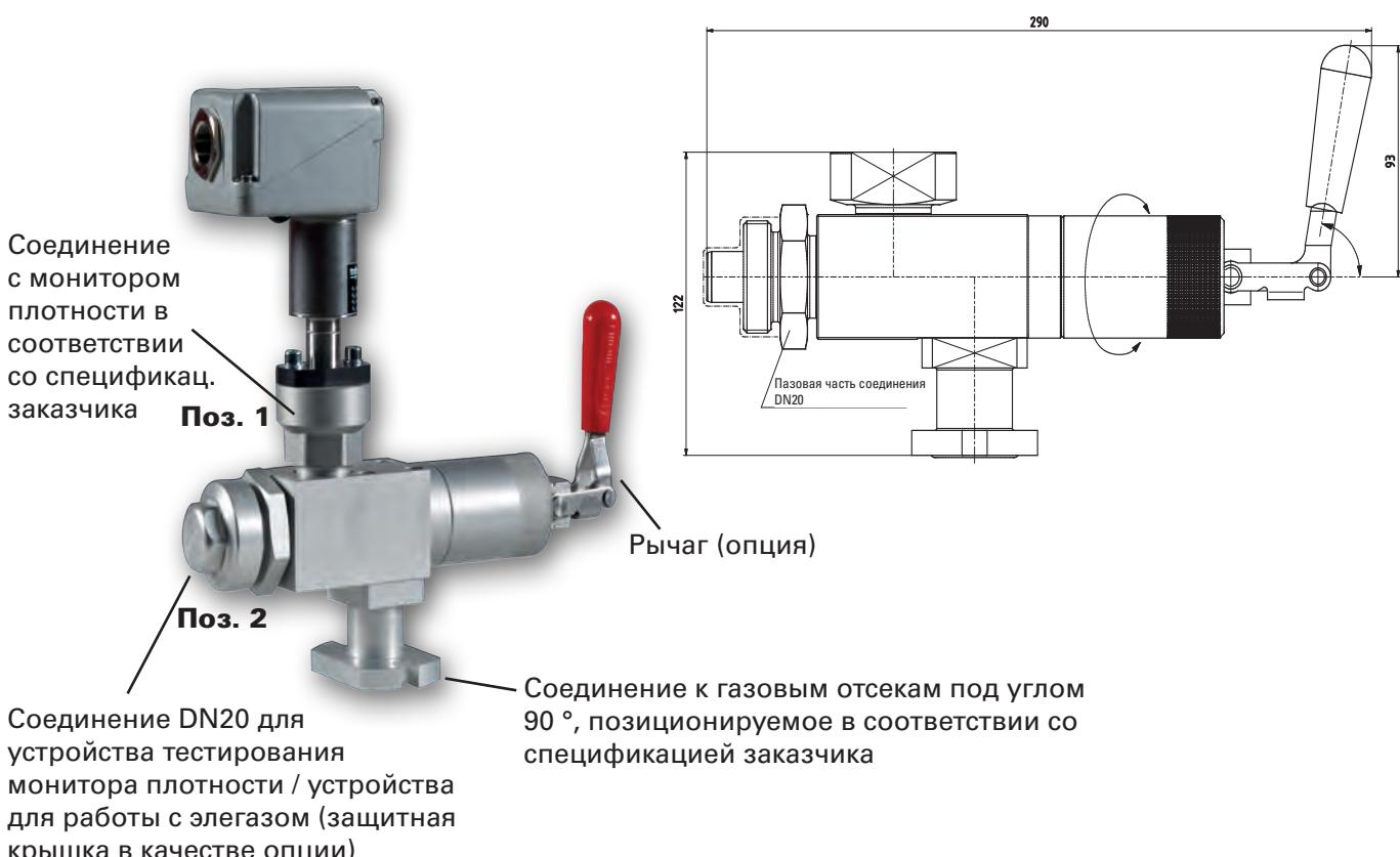
**Соединение с монитором плотности (Поз.1) и соединения (Поз.2) взаимозаменяемы – их расположение выполняется в соответствии с требованиями заказчика!**
