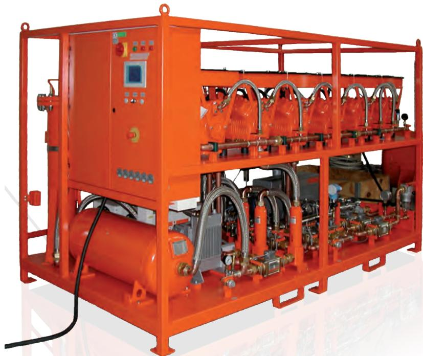
Установка обработки элегаза для электронных ускорителей
